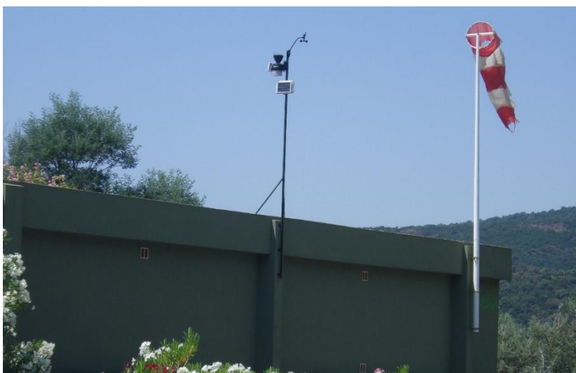
Figure 4 : Photographie du pluviomètre situé au niveau de l'héliport
